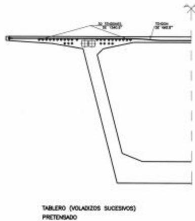
En segundo lugar está el pretensado de continuidad constituido por tendones de  $12\phi 0,6''$  situados en la tabla inferior de la sección. En tercer lugar se plantea un pretensado exterior de servicio formado por 8 tendones de  $24\phi 0,6''$  en el vano central y 4 en los laterales.
