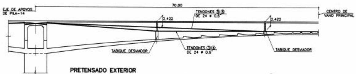
Por último, la losa superior de la sección está pretensada transversalmente por unidades de  $4\phi 0,6''$  colocadas dentro de una vaina plana.
