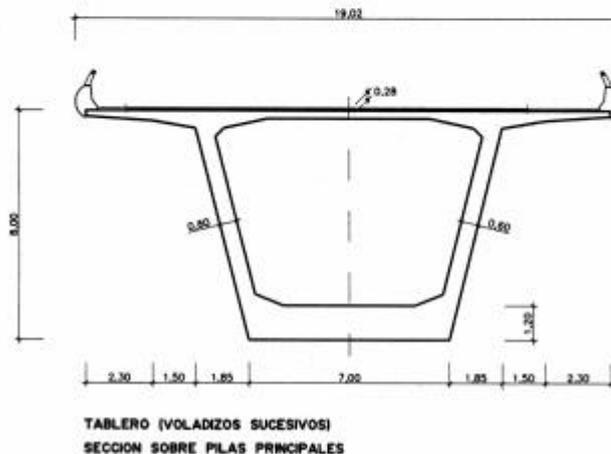
En el vano central se disponen 4 tabiques dentro de la sección para desviar el pretensado exterior de servicio. Del mismo modo se disponen dos tabiques desviadores en cada uno de los vanos laterales. Dichos tabiques no solo permiten la desviación de los tendones exteriores sino que además proporcionan una coacción frente a la distorsión de la sección cajón.
