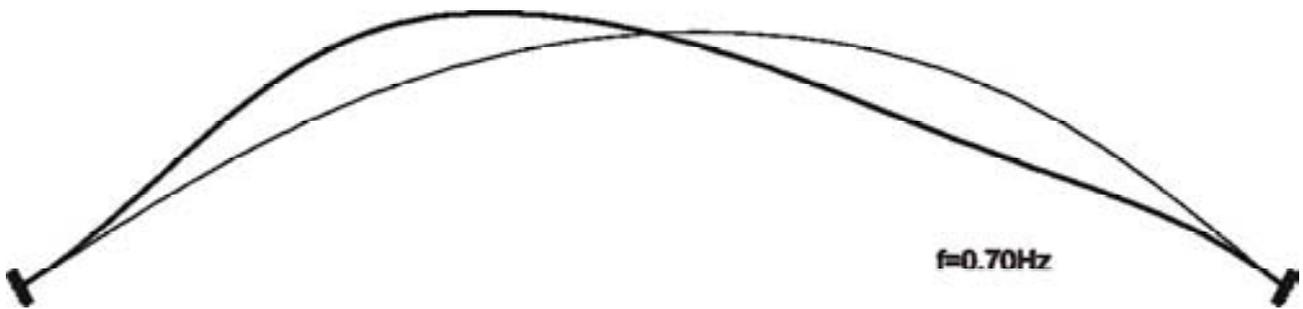
Fig. 2. Modo de vibración antisimétrico
