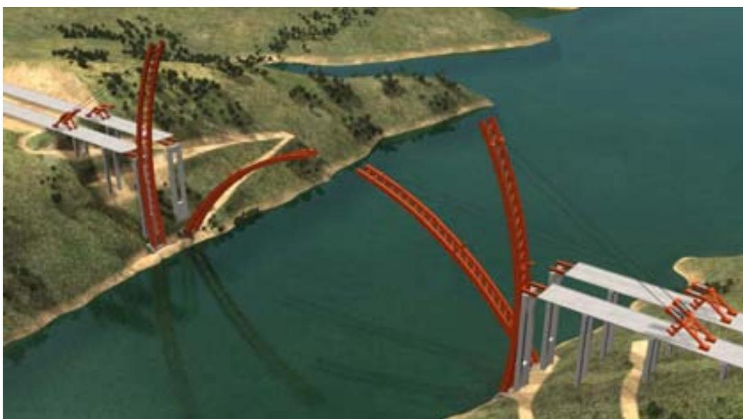
En la parte inferior de los arcos existe una pieza especial de soporte, cuya base posee un sistema de deslizamiento en dirección longitudinal según el eje del puente. Se ha dispuesto una batería de gatos en posición horizontal, de tal forma que mediante una accionamiento diferencial es posible controlar el movimiento transversal del extremo de los semiarcos en situación de abatimiento para ajustar al máximo la posición de encuentro en la zona de clave.
