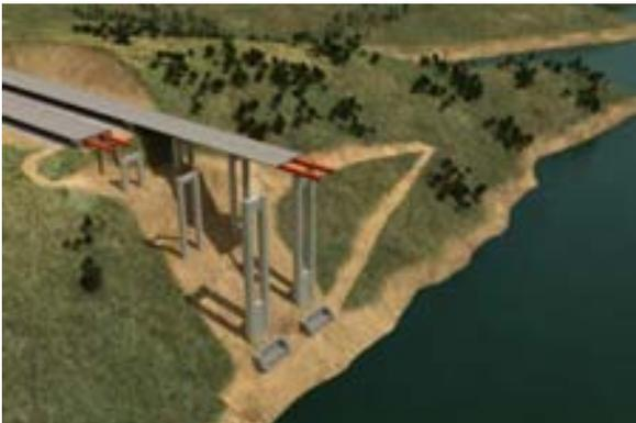
*Fig. 4 Empuje de tableros hasta alcanzar pilas cercanas al embalse*
