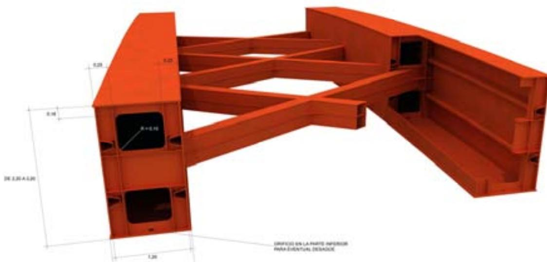
Se ha cuidado especialmente el detalle de unión de los arriostramientos con el arco, habiéndose evitado la disposición de cartelas metálicas vistas en el
