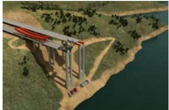
*Fig. 5 Desmontaje de los 13 m frontales de las vigas metálicas. Montaje del primer cuarto de arco sobre el tablero y desplazamiento hasta la parte frontal*
